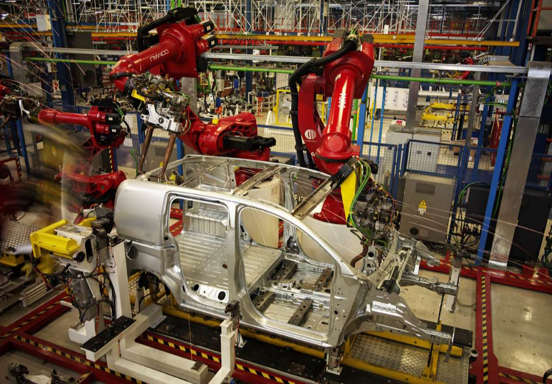
Autó összeszerelő sor (karosszéria elemeinek robotizált összehegesztése: 2010)
