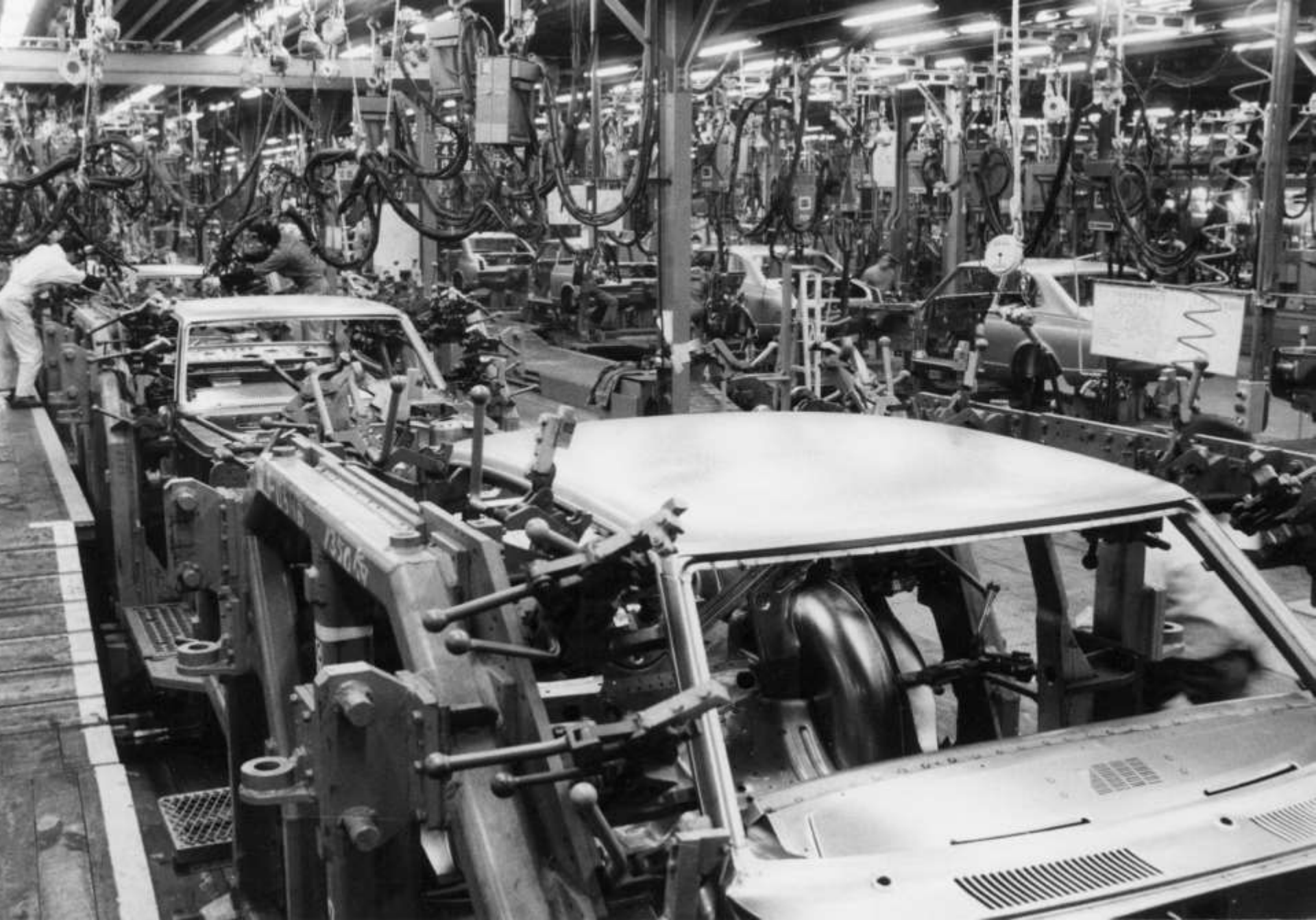
Autó összeszerelő sor (karosszéria elemeinek összehegesztése: 60-as évek)
