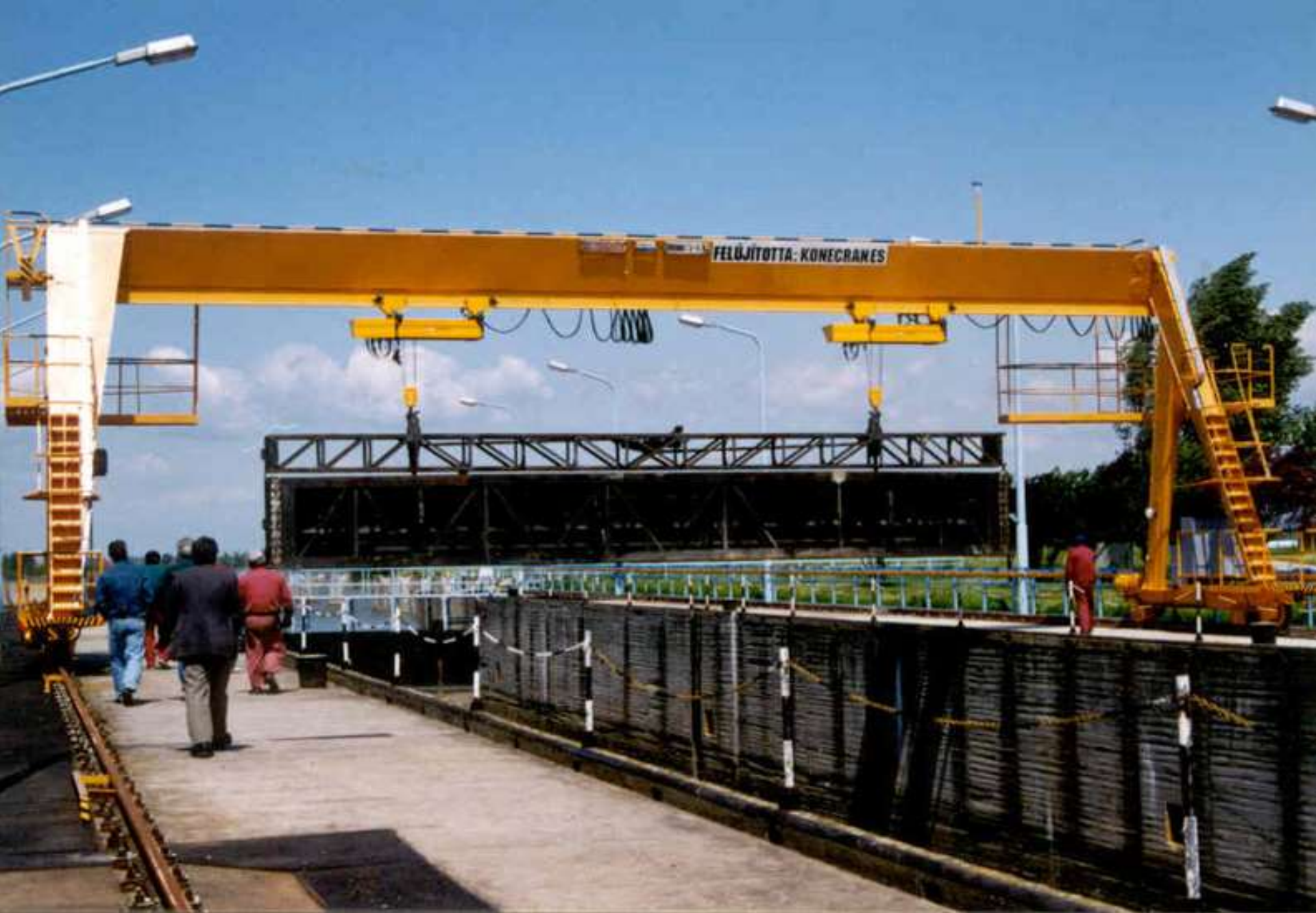
portáldaru (bakdaru) a terepen (padlón) fekvő sínen mozog
