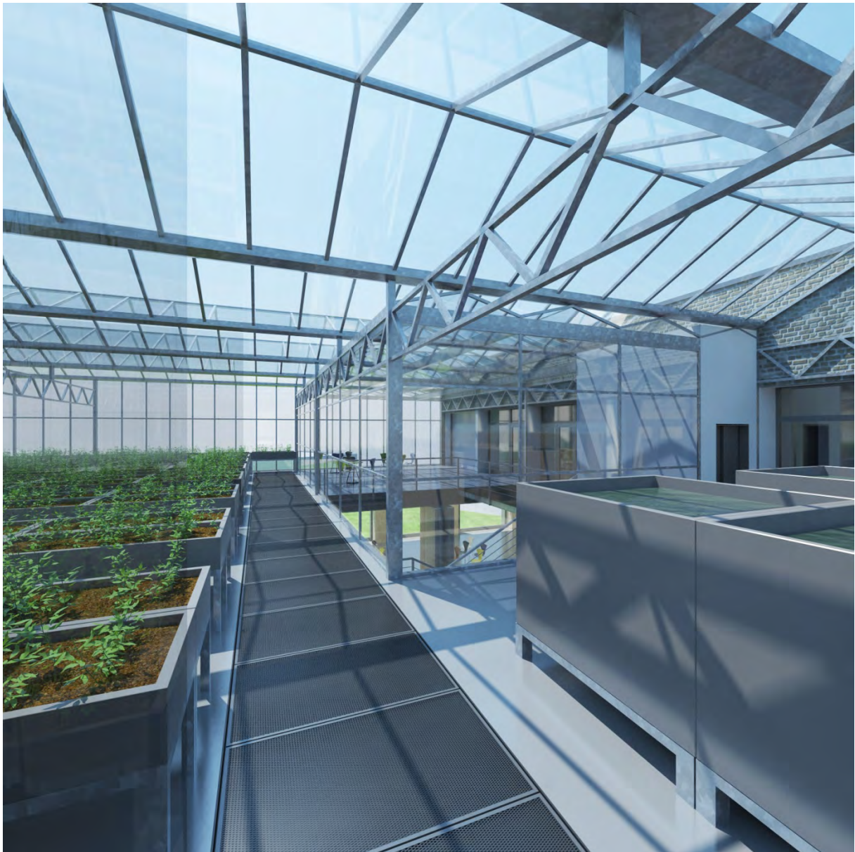
Az AKVAPÓNIÁS KUTATÓHÁZ belső képe. Az üvegház. Nézet az akvapóniás térből a „buborék”, a látogatótér felé (a lenti folyosó és előadóterem is feltűnik). Jobbra a halas medencék, balra a növénytálcák sora látható. A két akvapóniás alapfunkció kapcsolatául szolgáló csővezetékrendszerek középen a taposórácscsal lefedett padlócsatornában húzódnak. A növénytermelő rész fóliafüggönyökkel hajónként elhatárolható.
