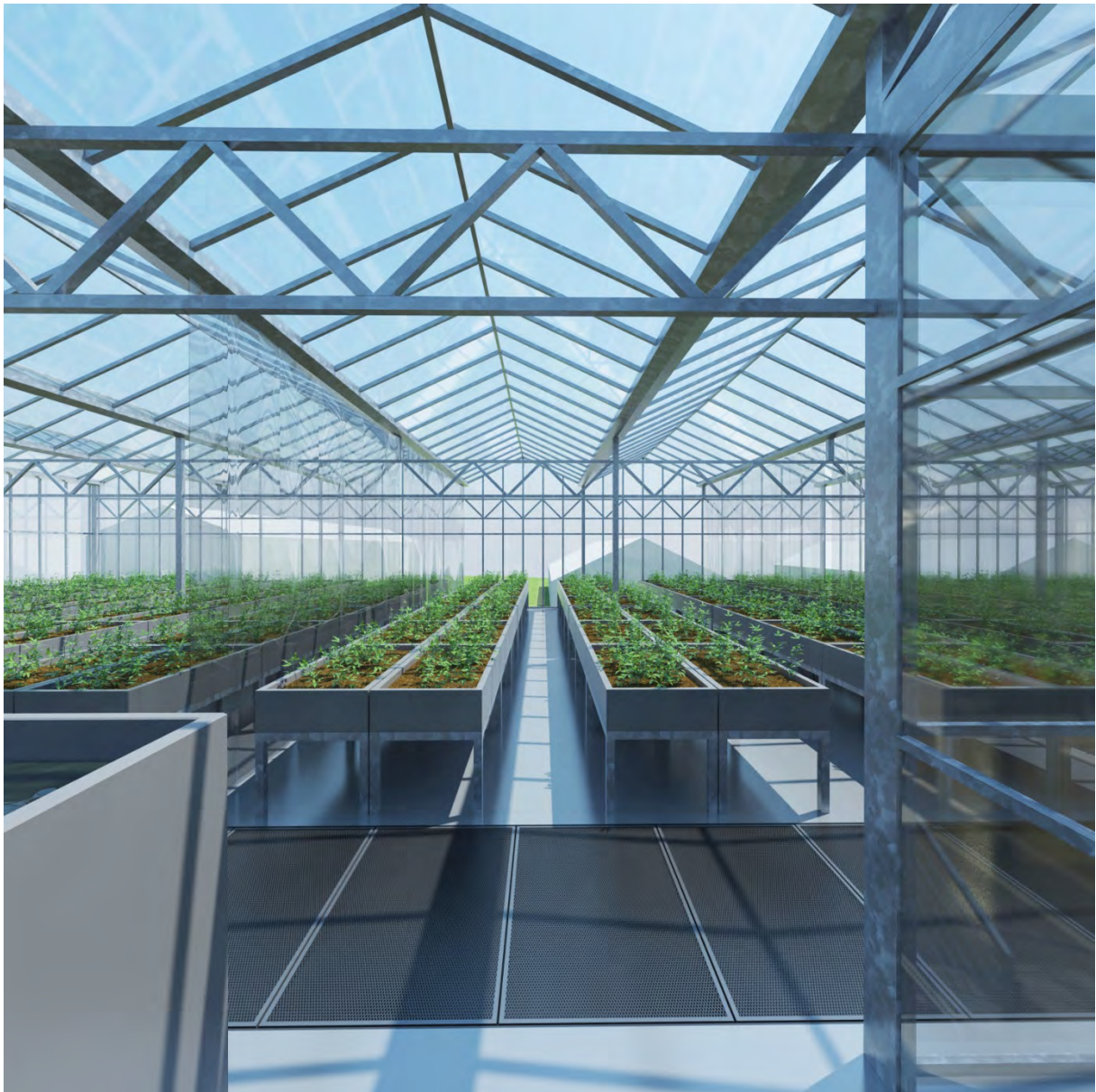
Az AKVAPÓNIÁS KUTATÓHÁZ belső képe. Üvegház. Nézet az előbbivel ellentétes irányba dél felé. Az előtérben balra az egyik haltartály, előtte a csővezeték hálózat padlócsatornáját fedő taposórács fedél, a háttérben a növénytálcák sora. Az egyes hajókat elválasztó, a vápákra függesztett átlátszó műanyagfüggönyök is kivehetők.
